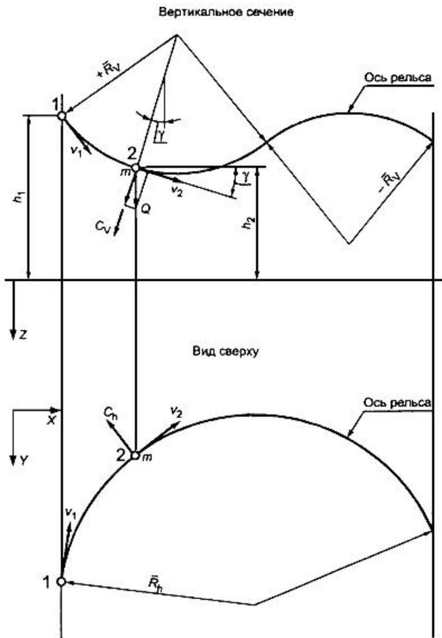
Рисунок В.7 - Вертикальное сечение и вид сверху рельсовой колеи
