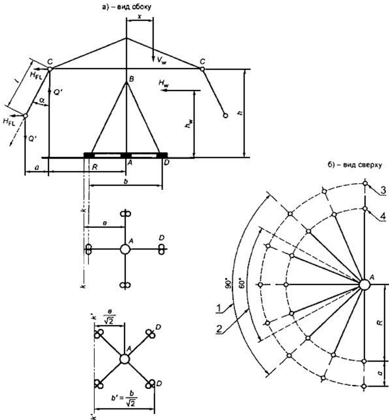
1 - односторонняя загрузка на 1/4 периметра в соответствии с 7.5; 2 - односторонняя загрузка на 1/6 периметра в соответствии с 7.6; 3 - вылет гондолы при максимальном угле отклонения подвески; 4 - точка подвески гондолы
