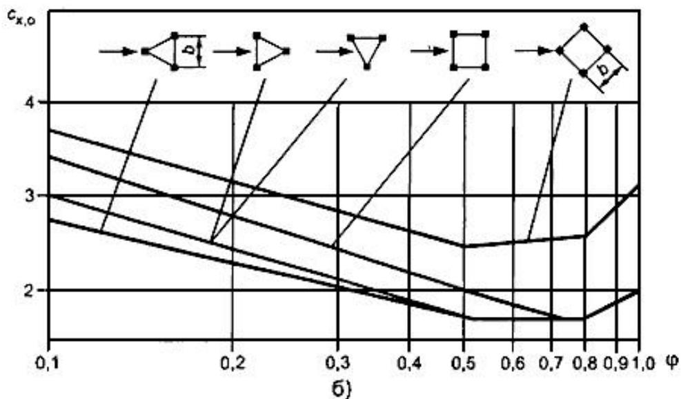
Рисунок Б.3 - Аэродинамические коэффициенты плоских а) и пространственных б) решетчатых ферм, составленных из профилей
