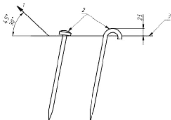
1 — направление прилагаемого усилия; 2 — формы закручивания головок анкеров;
